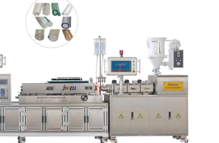
该系列设备由单螺杆挤出主机、挤出模具、真空成型冷却水槽、小皮带牵引、伺服切断机组成,客户可根据需求选配输送
